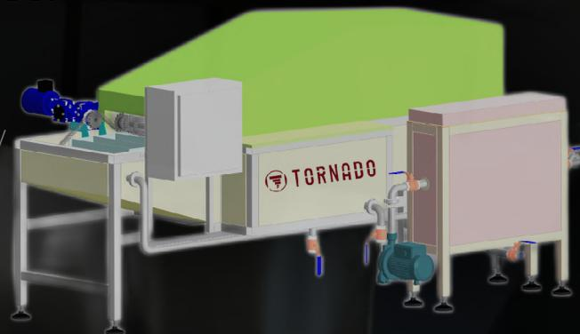
Фритюрница непрерывного действия Торнадо ФНД-100 оборудована механизмом регулировки расстояния между верхним и нижним конвейерами, лопатками для формирования секций и жарки сыпучих продуктов. В базовую комплектацию входит 2-х ступенчатый контур фильтрации, внешний теплообменник с предустановленными ТЭНами и профильное управление рецептами жарки продукта.
